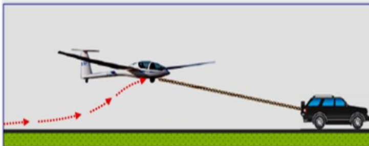
وینه ۲۶ خیرایی راکیشانی زۆر بهرز- فرۆکه که بهم خیرایه نتوانیت ههلبگرت چونکه خیرایه کی زیاتره له خیرایه یگه پیلراو
